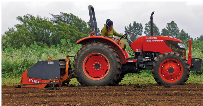
FIGURA 1. Un arado de palas (spader) se puede usar para incorporar cultivos de cobertura. Foto: Elizabeth Birnbaum
