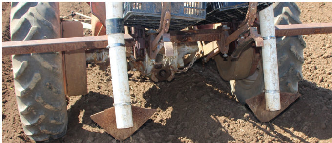
FIGURA 2. Rejas tipo "Alabama" con tubos o mangueras para colocar las semillas de papa. Foto: Martha Brown
