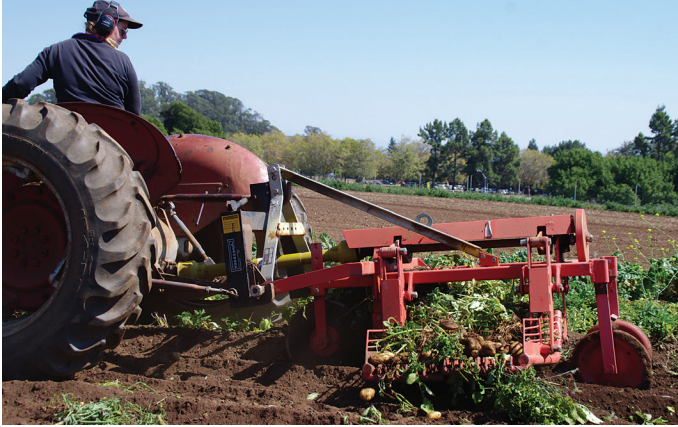
FIGURA 9. Ejemplo de una cosechadora accionada por la toma de fuerza (PTO) con tolva vibradora. Foto: Martha Brown
