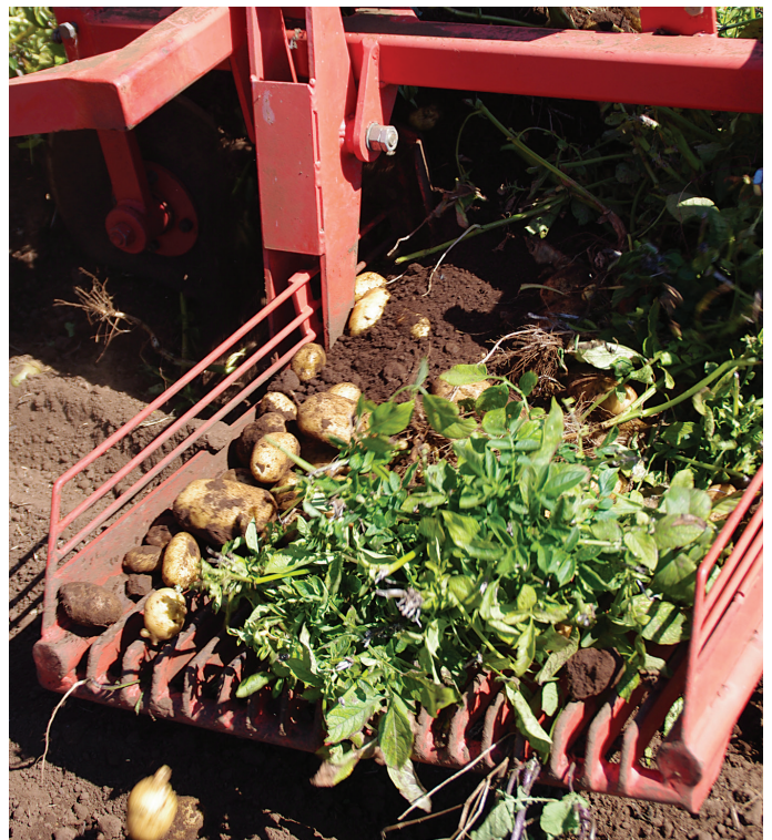
FIGURA 10. La tolva vibradora deposita las papas sobre la superficie del suelo. Foto: Martha Brown
