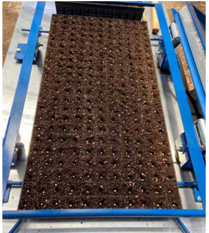
FIGURA 17. Semilla de lechuga recubierta recién puesta con una sembradora al vacío, ya con los orificios dispuestos para la semilla, con la tabla "Dibble".
