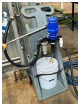
FIGURA 26. Inyector de fertilizante en plataforma móvil con accesorios de bloqueo de levas que puede ser fácilmente conectado/desconectado y trasladado del invernadero a la parcela y viceversa. Foto: Christof Bernau
