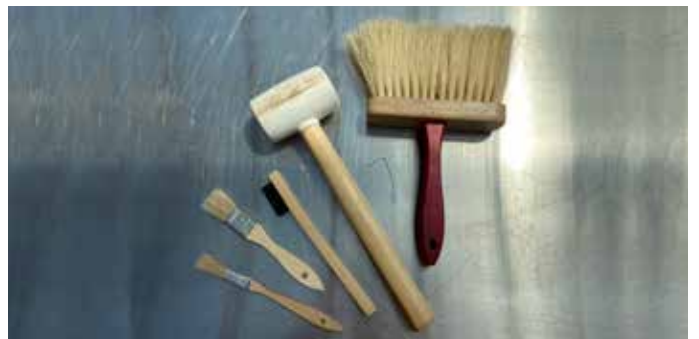
FIGURA 18. Cepillos y mazo para limpiar la sembradora al vacío, eliminar el depósito de doble semilla y apartar las semillas para llenar los huecos en el plato de semillas Fotos: Christof Bernau
