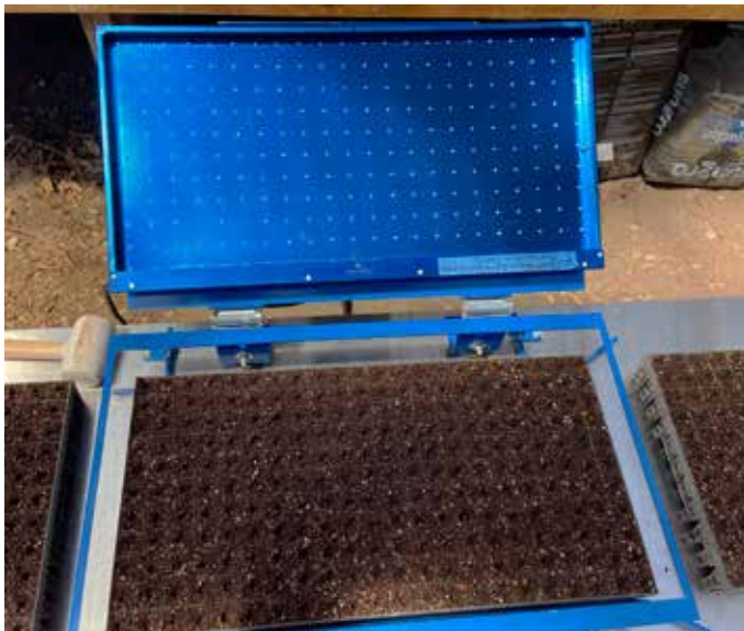
FIGURA 16. Sembradora de vacío en operación con semillas recubiertas de lechuga retenidas en su lugar y listas para ser depositadas en cada celda.
